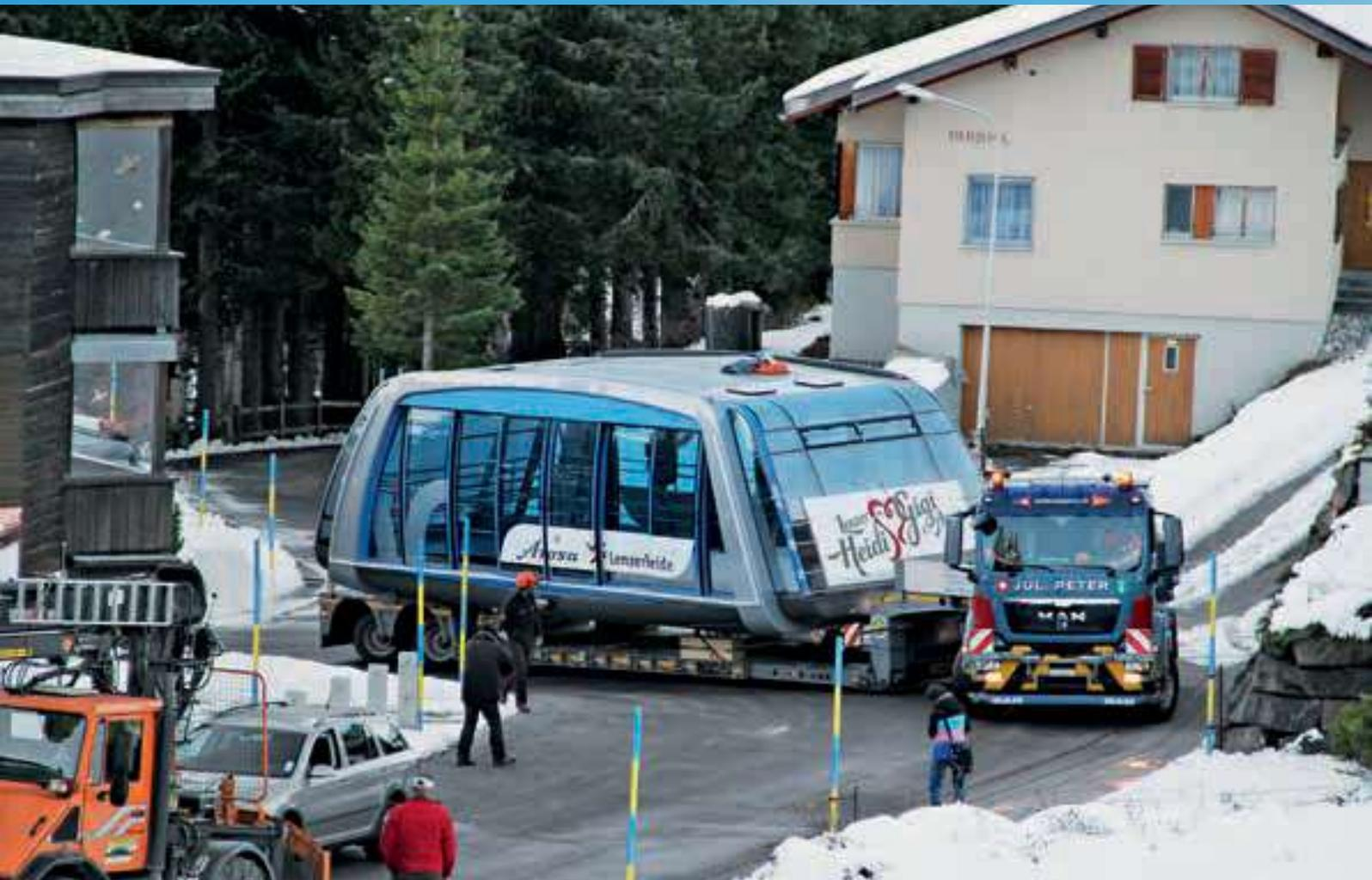
Spezialfahrzeuge über Fernsteuerungen betrieben. Der jeweils vordere Operateur ist für die Fahrgeschwindigkeit und die Lenkung des vorderen Triebkopfes zuständig. Der hintere Triebkopf wird von einem zweiten Operateur gelenkt. Dieser hat aller-
